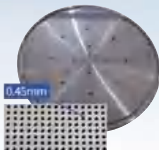
单晶硅喷淋盘微孔加工应用
